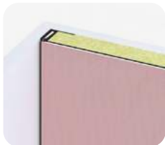
Chant non visible : baguette nue
