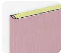
Chant visible : baguette gainée
