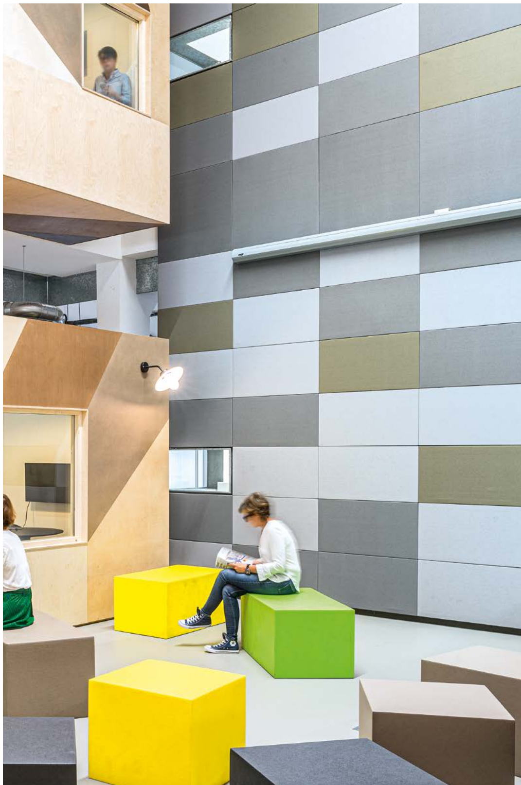
Panneaux acoustiques Stereo fixés au mur, installés en 2000 puis réhoussés et réinstallés pour le nouvel occupant en 2016. Paris, bureaux d'entreprise. Architecte Colliers International, Audrey Dudoit, 2016.
