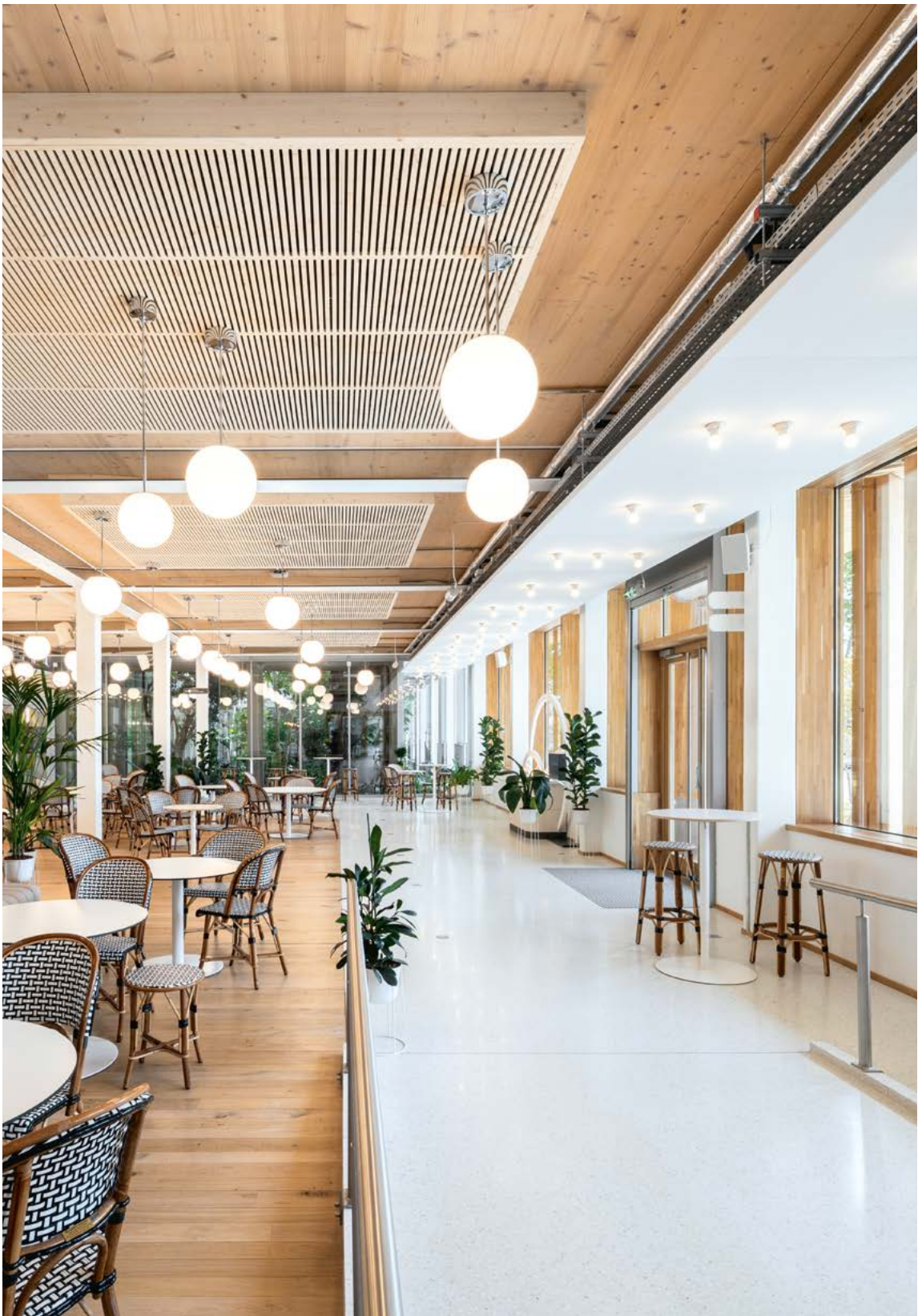
Panneaux acoustiques Stereo suspendus au plafond, liés, avec insertion de luminaires. Clermont-Ferrand, siège social de Michelin, ©Michelin 2021, café Équateur. Architecte Encore Heureux, chef de projet Romain Leal, 2021.
